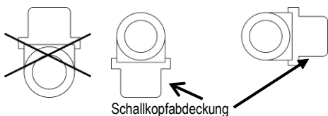
Abb. 4: Empfohlene Einbaulage bei Kältezählung
